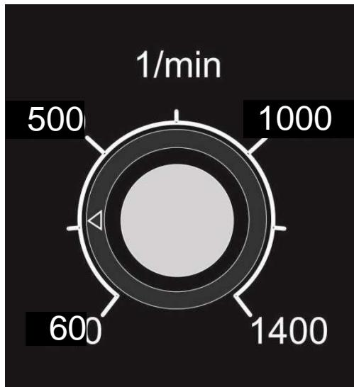
La regulación de la velocidad se realiza de forma continua al girar el botón de ajuste de velocidad en el sentido de las agujas del reloj. La velocidad está indicada por la escala.
