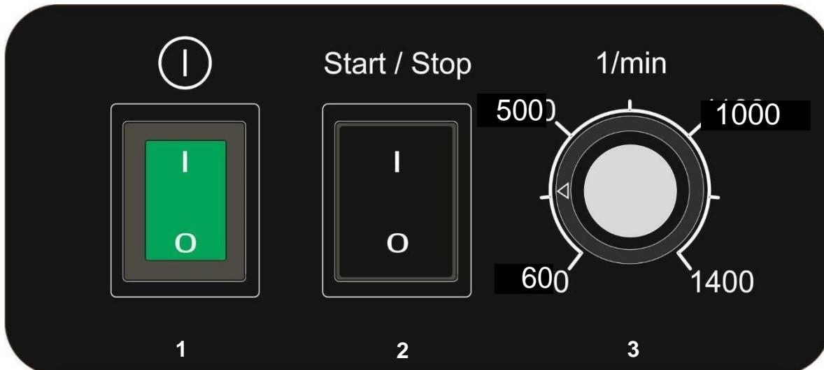
Interruptor basculante 1 Interruptor de red para encender la tensión de alimentación. Si el dispositivo está encendido, el interruptor 1 se ilumina en verde.
