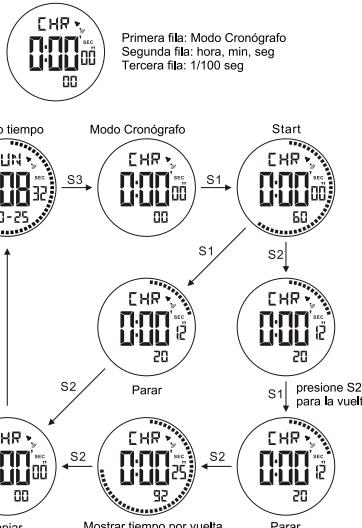
Máximo del Cronógrafo es 23 horas, 59 minutos y 59 segundos, 99/100 seg y tiempo de ciclo automático
