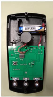
3. Ya podemos sustituir la pila de LR6 1.5V AA
