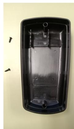
2. Aflojar dos tornillos que hay en la parte trasera del aparato.
