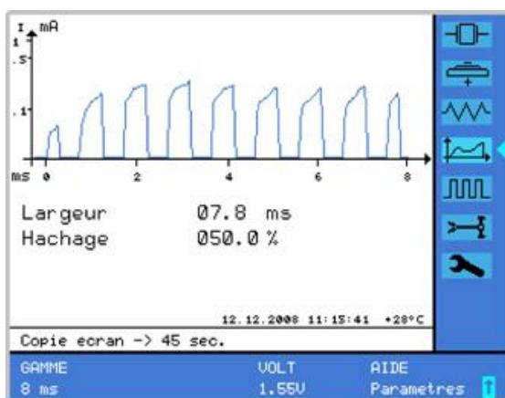
Los impulsos del motor son representados por una curva. La forma de los impulsos constituye un criterio de determinación importante del buen funcionamiento de un reloj. Medidas comparativas con otro reloj del mismo modelo en buen estado, permiten detectar defectos de la parte mecánica.
