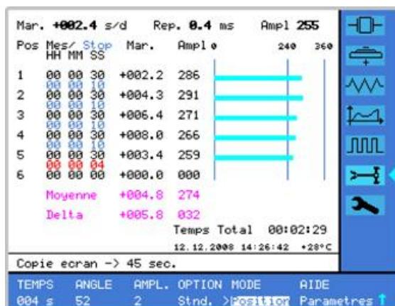
Este modo permite definir ciclos desde 2 hasta 6 posiciones de medida por rotación manual del micrófono. Los valores instantáneos de la marcha, del punto muerto y de la amplitud del volante son medidos y acumulados. La media de la marcha y de la amplitud de cada posición es reflejada al final del ciclo de medida. Los valores de medida de la amplitud son representados también por una barra de color azul claro.
