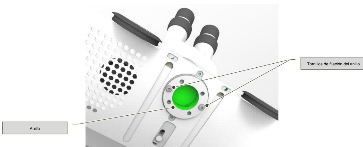
Fig. 9-2 – Sustitución del cristal de protección especial
