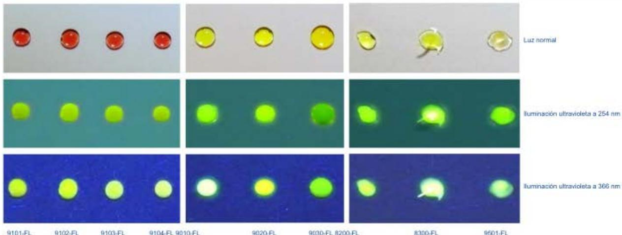
Bajo la luz ultravioleta, la gota de lubricante emite una luz verde amarilla (alrededor de 550 a 600 nm).
