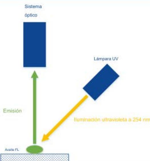
La visualización requiere un equipo específico como unos binoculares equipados con una lámpara UV iluminadora entre 254 – 366 nm.
