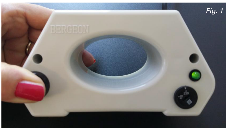
Abb. 1: Entmagnetisier Apparat ist an, die LED leuchtet grün.
